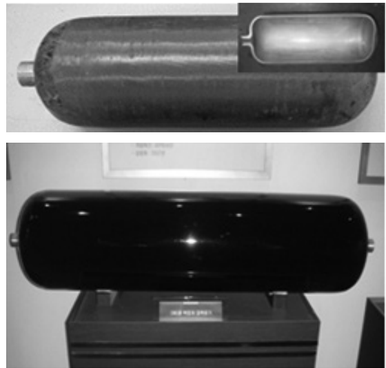
[그림 3] 전자선 이용 고강도 탄소섬유 복합재(CFRP) 압력용기 개발: 산소 탱크(위), LNG 탱크(아래)
