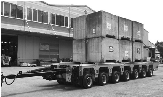
[그림 8] 고리 운반트레일러(모듈 타입) 하중시험
