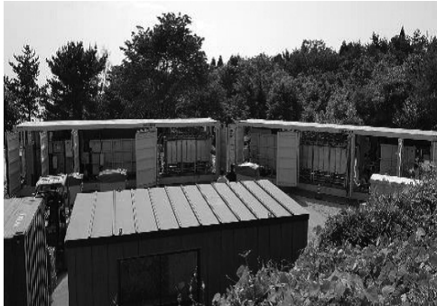
[그림 6] 이동형 소각재 제염 설비 실증시험 현장(일본 후쿠시마현)과 흡착재 카트리지 모듈
